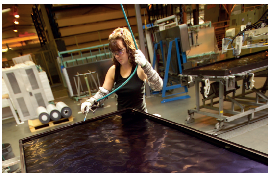
Capteur solaire thermochrome à l'usine Viessmann de Faulquemont © Viessmann
